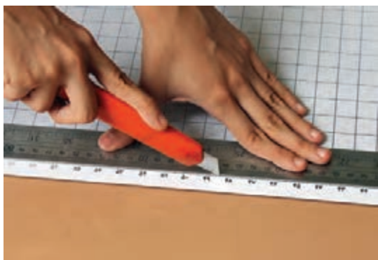
شکل ۴۰-۱- روش برش لبه اضافی کاغذ با کاتر
