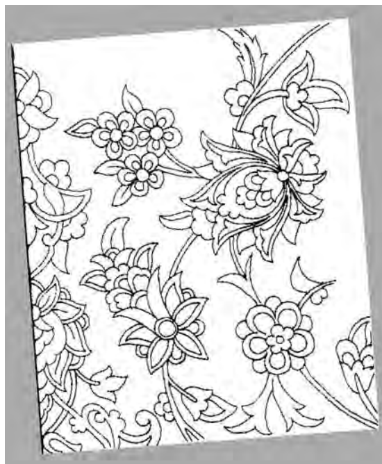
شکل ۴-۸۷- اشکال در نحوه قراردادن تصویر روی صفحه اسکنر
