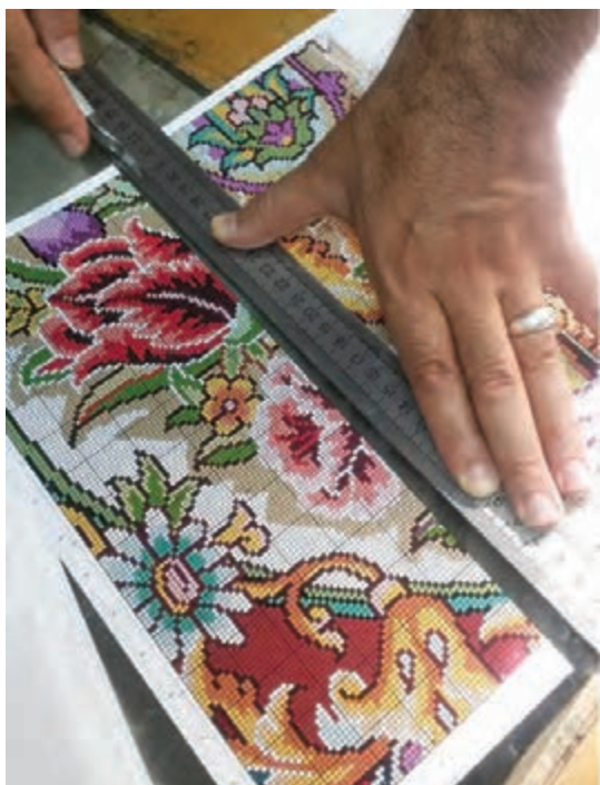
شکل ۲- ۵- برش نقشه با ابزار کاتر (روش صحیح)
