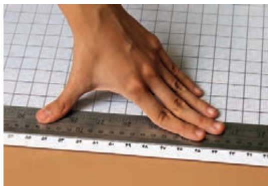
شکل ۳۹-۱- روش مهار کردن خط کش فلزی با دست
